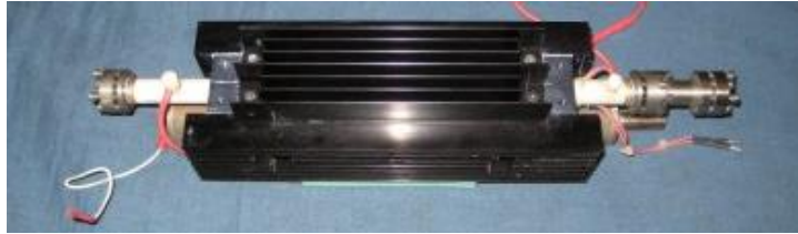
14-1:ليزر ثاني اوكسيد الكربون من نوع موجة الموجة Wave Gide يعطي قدرة تصل الى عشرة واط ، على الرغم من ان طوله لا يتجاوز 30 سم.
