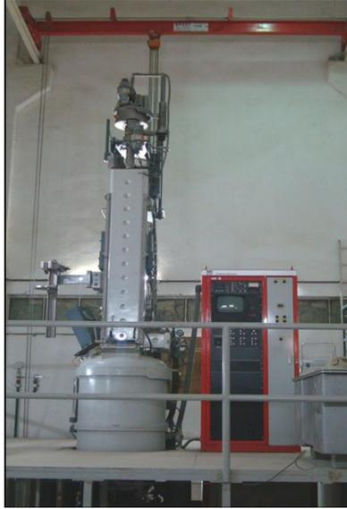
شكل (٣-١٠): جهاز الانماء البلوري (Puller)
